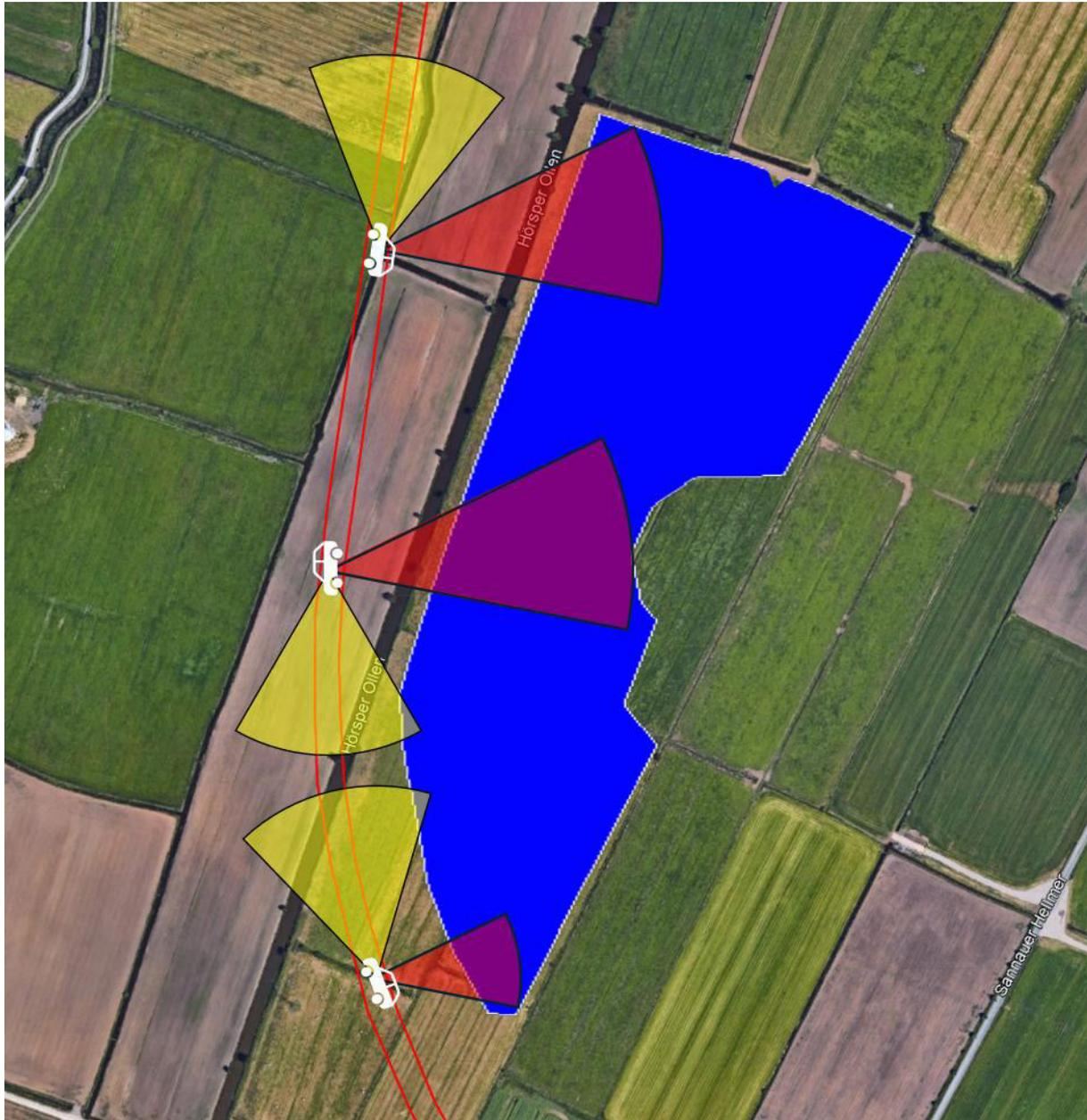
Abbildung 14: Relevante Sichtwinkel der Verkehrsteilnehmer auf der B212n in Gelb, Immissionswinkel möglicher Reflexionen von der Modulfläche in Rot für drei Positionen (Quelle: Google Earth)
